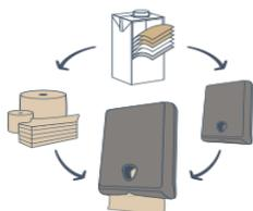
Durch ein exklusives, mechanisches Verfahren gelingt es Lucart, die Materialien von den Lebensmittelpackungen zu trennen, um sie vollständig zu recyceln. Die Zellulosefasern, deren Qualität der von reiner Watte ähnelt, werden zu Fiberpack®, aus dem die EcoNatural-Wischprodukte hergestellt werden. Aluminium und Polyethylen werden zu Al.Pe.®, das unter anderem zur Herstellung der EcoNatural Flow-Geräte verwendet wird.
