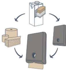
Durch ein exklusives, mechanisches Verfahren gelingt es Lucart, die Materialien von den Lebensmittelpackungen zu trennen, um sie vollständig zu recyceln. Die Zellulosefasern, deren Qualität der von reiner Watte ähnelt, werden zu Fiberpack®, aus dem die EcoNatural-Wischprodukte hergestellt werden. Aluminium und Polyethylen werden zu Al.Pe.®, das unter anderem zur Herstellung der EcoNatural Flow-Geräte verwendet wird.
